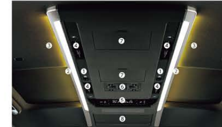
【照明】●読書灯● 後席用LEDドームランプ ●LEDルーフレアイルミネーション 【空調】●天井エアコン吹き出し口 ●リヤエアコンコントロールパネル 【操作】●おもてなし集中スイッチ* 【ユーティリティ】●天井収納ボックス ●後席ディスプレイ格納*
